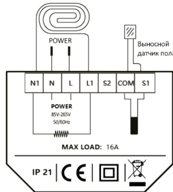
Для управления системой электрообогрева «теплый пол», подсоедините к клеммам COM и S1 выносной датчик пола NTC 10K, входящий в комплект поставки.
