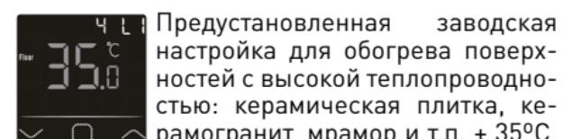
Предустановленная заводская настройка для обогрева поверхностей с высокой теплопроводностью: керамическая плитка, керамогранит, мрамор и т.п. + 35°C. Для обогрева поверхностей с низкой теплопроводностью: ламинат, паркетная доска, ковролин и т.п., измените значение до + 28C. А так же воспользуйтесь рекомендациями производителей напольных покрытий.
